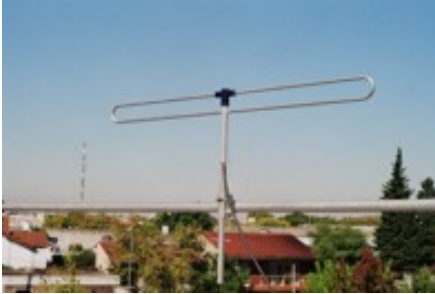
Dipolo en proceso de medición
